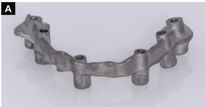
Abb. 9: (A) Das Gerüst der bogenumspannenden Rekonstruktion wurde aus einer Kobalt-Chrom-Legierung (Coron®, Straumann, Basel, Schweiz) gefräst und (B) für die Verblendung vorbereitet.
