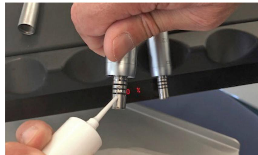
Tropf vom Silikon auf die untere Hälfte der O-Ringe vom Mikromotoransatz und mit Handschuhen verteilen
