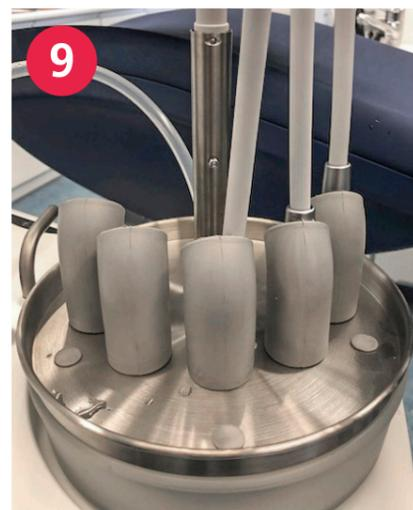
9 Mikromotor parallel zum Unit einstecken
