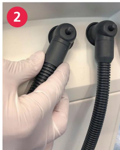
2 Saugschläuche von der Einheit lösen
