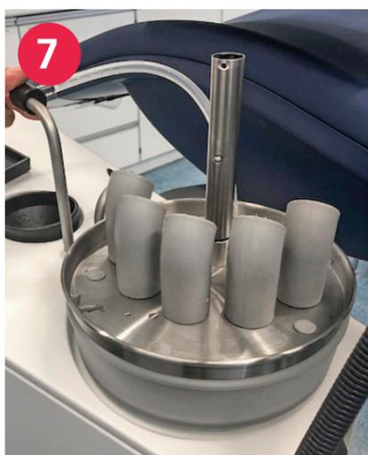
7 Spülanlage an Wasser anschließen (bis zum Anschlag andrücken)
