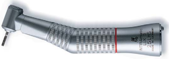
Rotes Winkelstück mit fixem Kopf 1 : 5 Übersetzung Max. Drehzahl 200'000 U/min Schleifkörperschaft- Ø 1.6 mm
