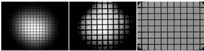
Abb. 5: Die objektive Vermessung von zahnärztlichen Lupen an einer optischen Fachhochschule ergab grosse Unterschiede zwischen den einzelnen Lupen. Das gleiche Raster fotografiert durch eine Galilei-Lupe (links, deklariert 2.8x) und zwei Kepler-Lupen (Mitte und rechts, deklariert 3.5x resp. 3.6x). Zu beachten ist der Zusammenhang zwischen Arbeitsfeld und Vergrößerungsfaktor (links und rechts), aber auch der offensichtliche Qualitätsunterschied bei ähnlicher Vergrößerung (Mitte und rechts). Bei sämtlichen Lupen wurde eine Diskrepanz zwischen deklariertem und effektiver Vergrößerung gefunden.
