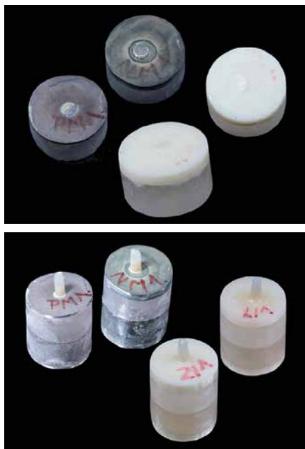
Abb. 2: Metallische und keramische Basisplatten nach künstlicher Alterung (oben) und nach anschließendem Neu-Aufbringen der keramischen Pins (unten) zur Testung des Haftverbundes zwischen metallischer oder keramischer Basisplatte und Verblendkeramik.
