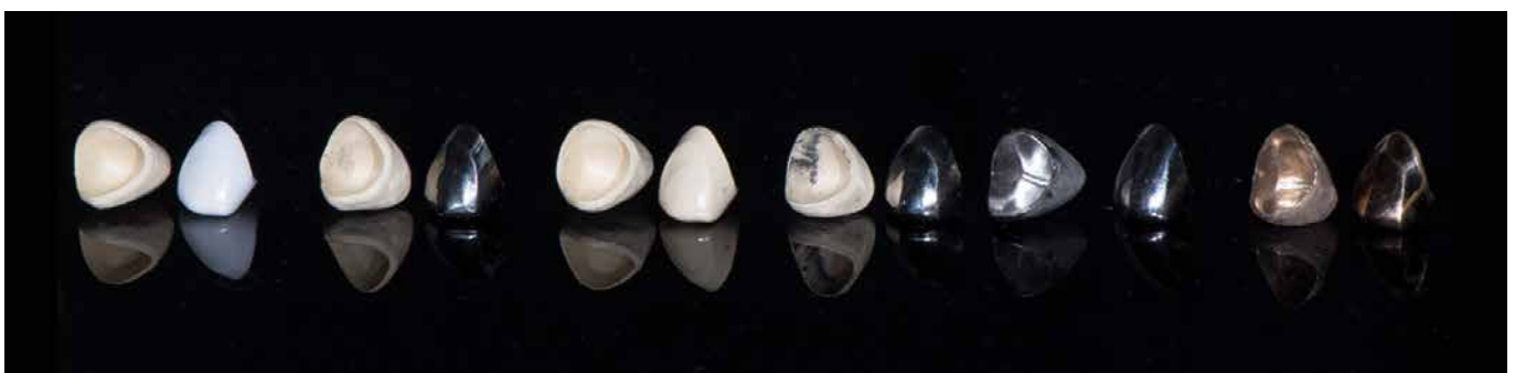
Abb. 1: Übersicht über die verschiedenen untersuchten Materialkombinationen von Primär- und Sekundärkronen.
